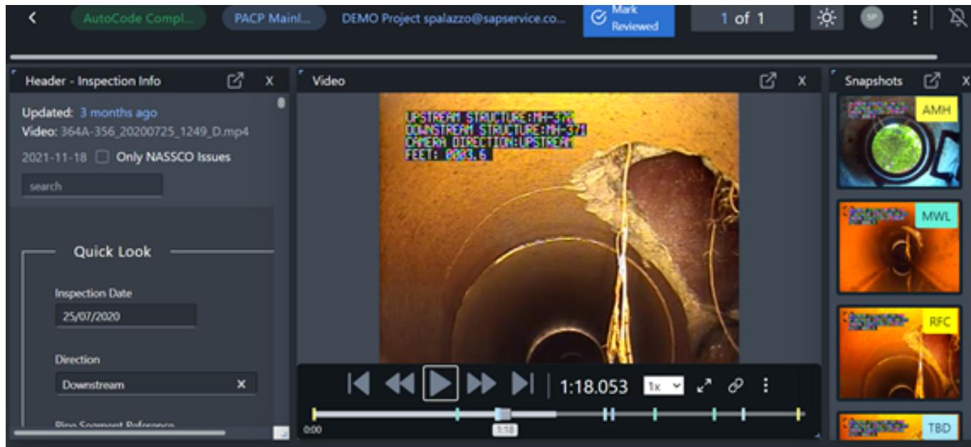
Numa imagem instantânea com se vê acima, o programa indica, a intrusão de raízes, uma contribuição lateral, com todos os seus detalhes dimensionais (posição, distância do PV, etc.) dentro das classificações da NASSCO.
